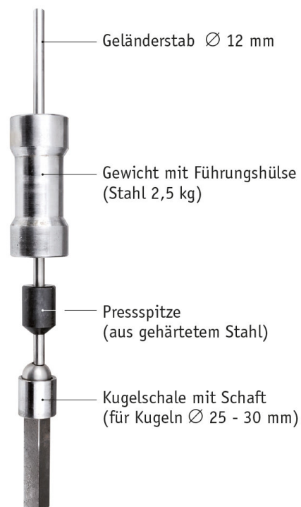
6 ... und mit Schwung das Gewicht mit der Hand auf die Pressspitze schlagen.
